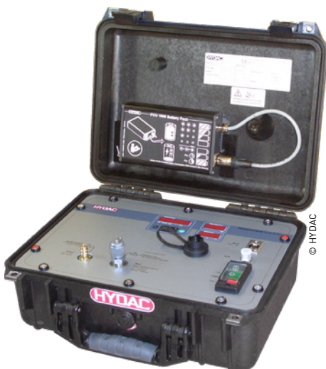
Les prélèvements d'huile réalisés par Hydac et les mesures effectuées avec un contrôleur de pollution permettent une surveillance des fluides sur une longue durée.
