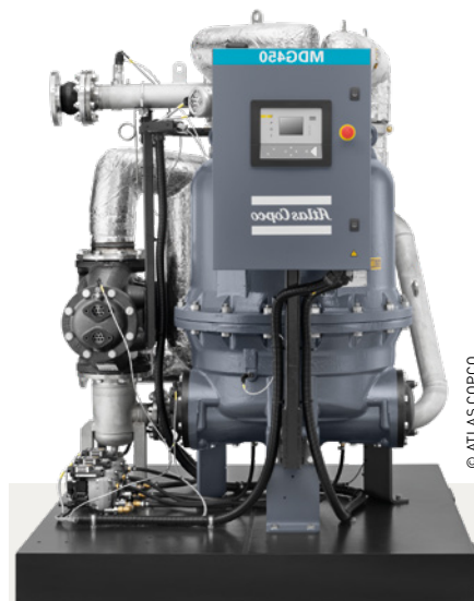
Les modèles de sécheurs MDG à tambour rotatif avec récupération de la chaleur produite par le compresseur garantissent un point de rosée stable à -40°C pendant tout le process.
