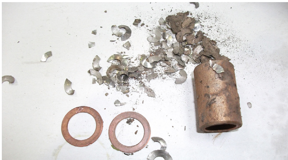
Exemple de pollutions solides trouvés lors d'une expertise de filtre IMF type F509.
