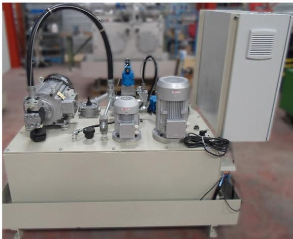
Groupe moto-pompe et armoire de commande pour centrale biomasse, réalisé par la société Hyd&Au Fluid.
