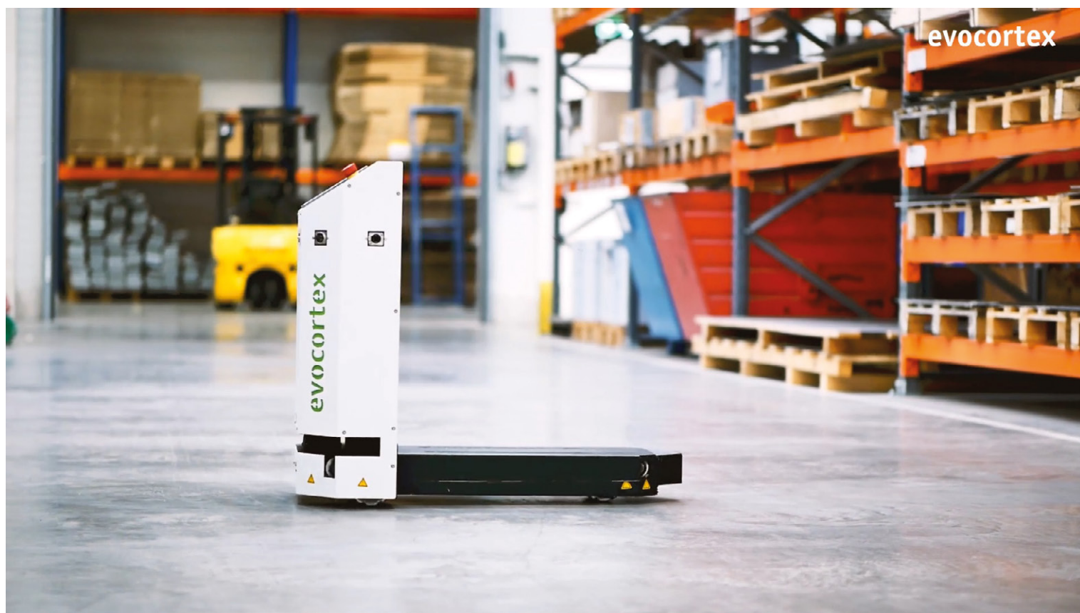
Les robots mobiles autonomes (AMR) d'Evocortex n'ont besoin d'aucun système de guidage préinstallé pour reconnaître leur emplacement et trouver le bon chemin.
