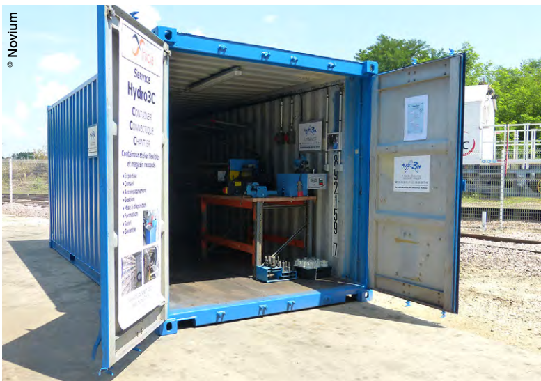
Le service Hydro 3C (Container, Connectique, Chantier) proposé par le groupe Inicia, porte sur l'installation sur les chantiers de containers équipés de flexibles, tubes et raccords hydrauliques et des outils nécessaires à leur confection (trouçonneuse, sertisseuse...).
