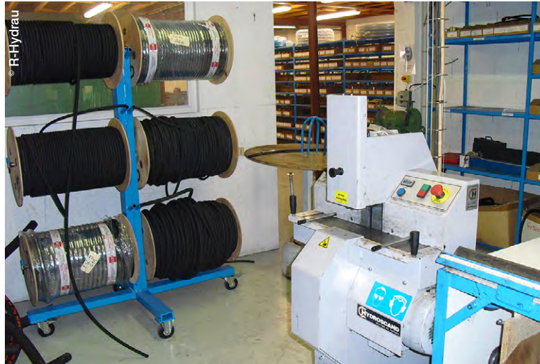
L'atelier hydraulique de R-Hydrau est équipé pour la confection des flexibles.
