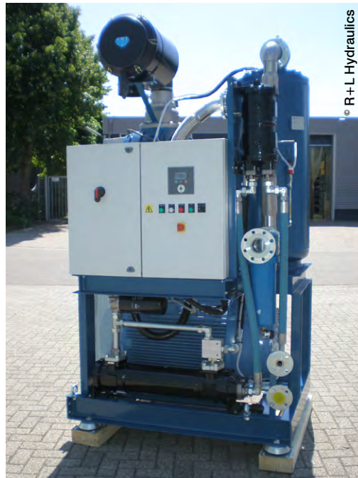
5. Compresseur à vis de la société Aerzen Niederlande B.V.
