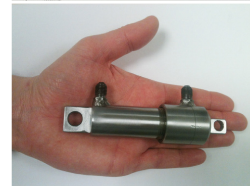
... aux plus petits vérins (390 grammes, course 50 mm, diamètre 20 mm)
