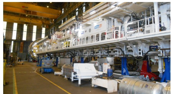
Hyd&Au Fluid a confié à AR Techman les châssis de quatre centrales hydrauliques de 10.000 litres destinées à un tunnelier NFM.
