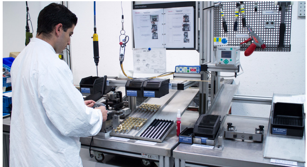
Chacune des stations de montage est dotée d'un écran permettant à l'opérateur de visualiser les composants et la bonne façon de les assembler.
