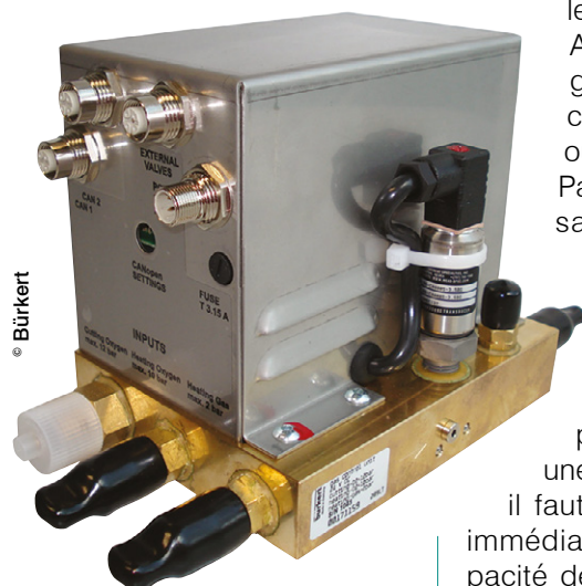
Bloc réalisé par Bürkert Fluid Control Systems pour l'oxycoupage, intégrant des électrovannes TOR et proportionnelles, des capteurs de pression, de l'électronique et des raccords fluidiques. Il permet la régulation en pression de différents gaz avant l'alimentation de la torche. Une électronique spécifique intégrée permet de réaliser les différentes fonctions. La communication du bloc se fait par bus « Can Open » intégré.
