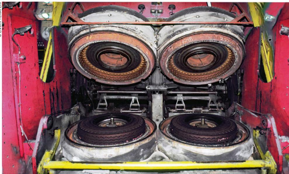
Une machine de moulage de pneumatiques.
