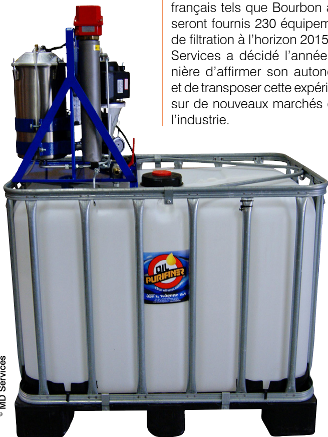
Cette centrale de dépollution montée sur un réservoir de 600 litres est équipée d'un réchauffeur, d'un pré-filtre et d'un tableau de commandes.
