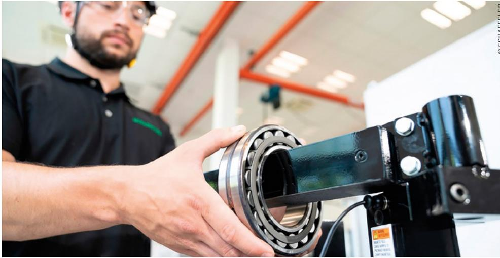
Schaeffler continue à développer sa gamme de services. Ici : les appareils de chauffage par induction permettent un chauffage des roulements économe en énergie et réduisent le temps de montage.
