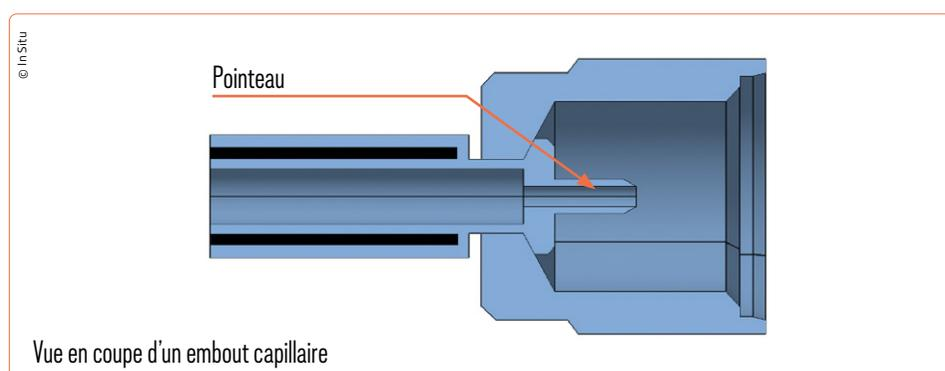
Des **inserts** seront sertis aux extrémités du tuyau, ce qui permettra au capillaire de se connecter notamment sur une prise de pression. Enfin, des bouchons seront positionnés sur les embouts afin de limiter l'entrée de pollution dans le système.
