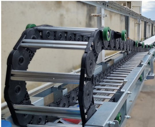
Le système est plus fiable que le rail car il n'y a aucun risque de faux contact.
