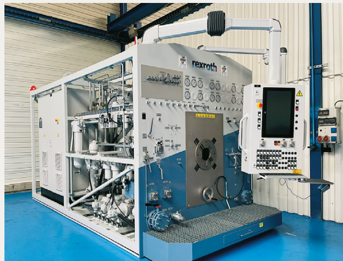
EDHD s'est équipé, en 2022, d'un banc d'essai ultraperformant Bosch Rexroth capable de vérifier et de tester 90% des pompes hydrauliques dans les mêmes conditions qu'en usine Bosch Rexroth.
