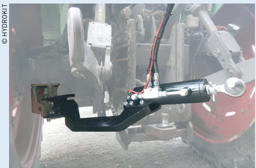
L'attelage quatrième point proposé par Hydrokit apporte une plus grande précision de mouvements.
