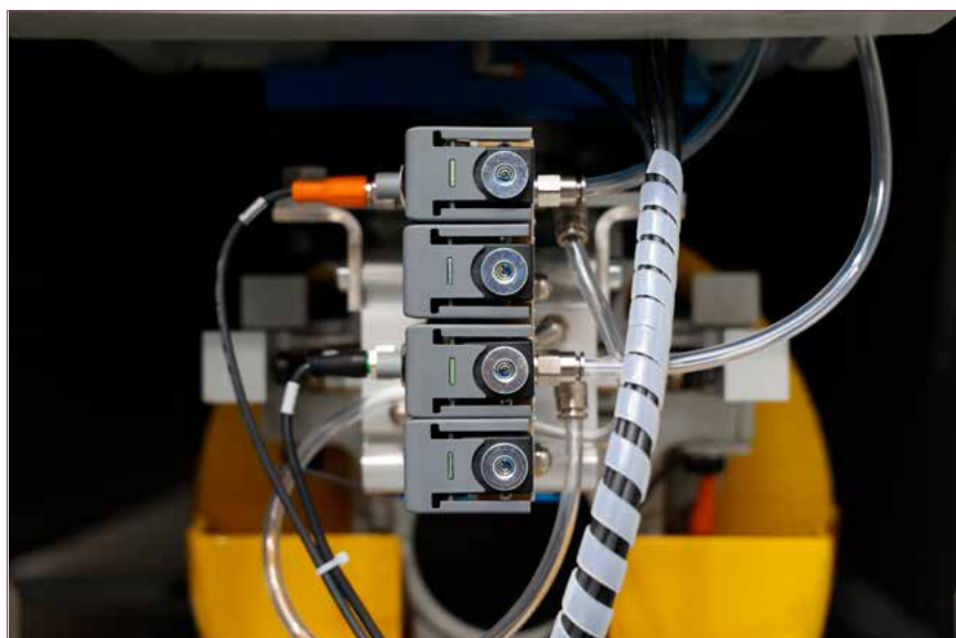
Régulateur proportionnel à structure ouverte. © Camozzi
