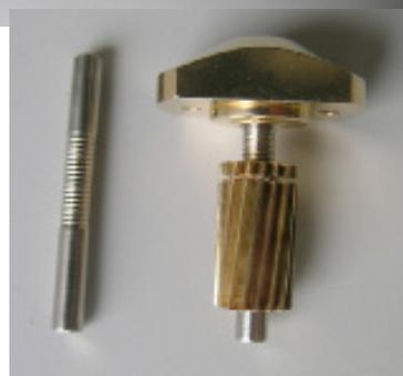
Pour équilibrer l'instrument, un écrou en laiton se déplace sur une vis filetée roulée fournie par Eichenberger et déplace un petit contrepoids (à gauche).
