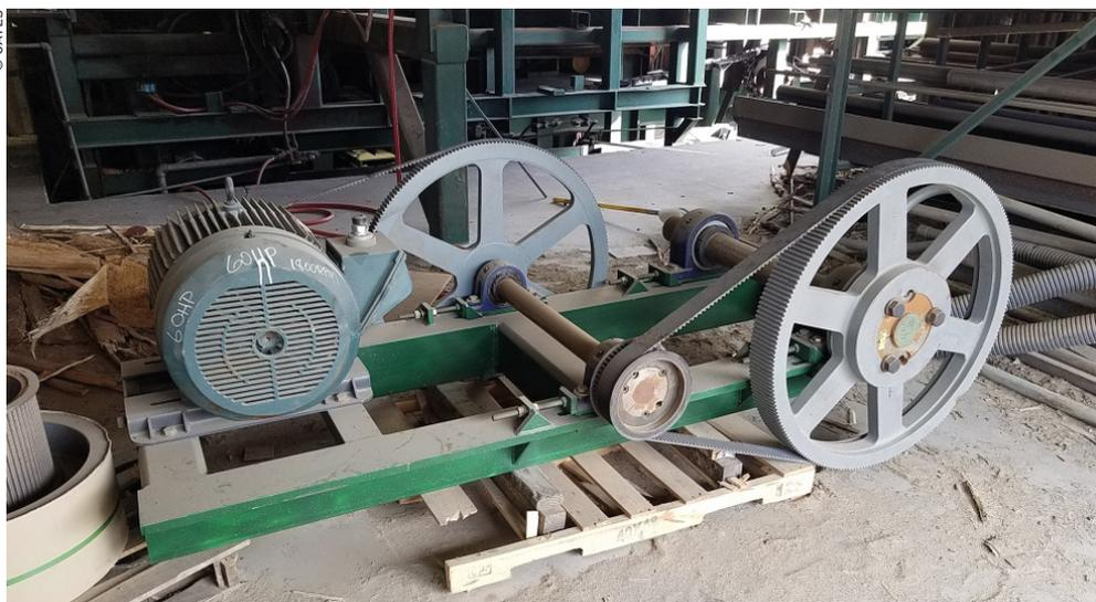
Double réduction 17,6:1 de 7,5 ch ; la première réduction (à l'extrême droite) est une courroie caoutchouc Gates PowerGrip GT3 de 20 mm de largeur et la deuxième réduction (au centre) est une Gates Poly Chain GT Carbon de 21 mm de largeur. On peut voir à l'avant-plan (à gauche) une chaîne à rouleaux #80 de remplacement.
