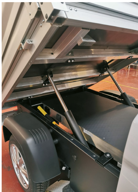
Ewellix a fourni un système de deux actionneurs CAHB-2xS avec une électronique intégrée qui peut synchroniser le mouvement grâce à des commandes E/S.
