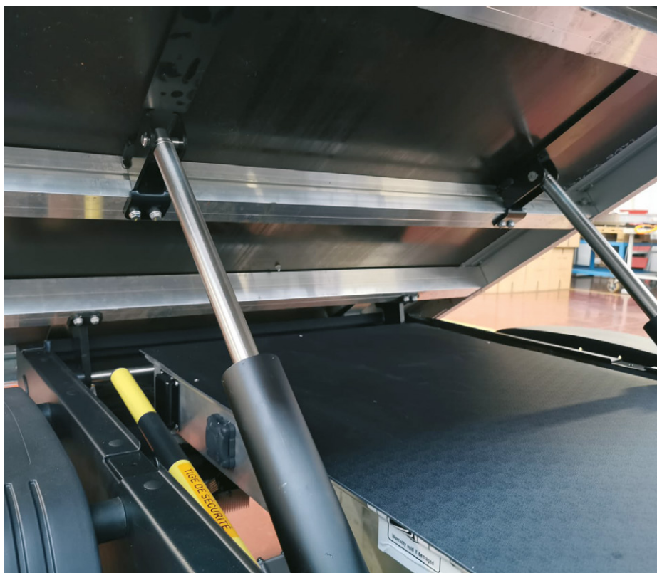
Les quadricycles de Regis Motor sont équipés d'une benne automatique entièrement électrique qui est plus flexible et plus efficace. Cela réduit le besoin de maintenance supplémentaire par rapport aux quadricycles existants sur le marché.
