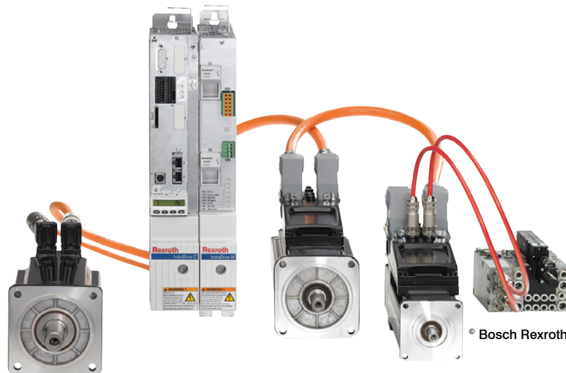
L'entraînement électrique IndraDrive Mi sans armoire réunit en un seul bloc le moteur et le variateur et génère des gains de consommation énergétique allant jusqu'à 90% grâce à la suppression de la climatisation.
