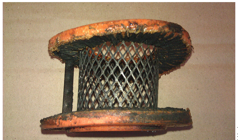
Filtre d'aération brûlé par une explosion dans le réservoir.
