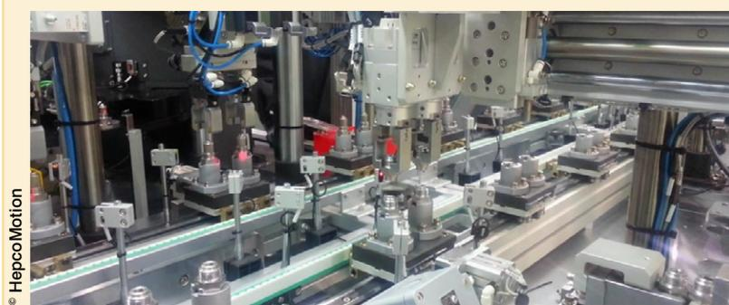
Le transfert et le positionnement de 28 outillages pour l'assemblage de capteurs de températures, dans l'industrie automobile, nécessite un niveau de précision élevée pour éviter les défauts. Les systèmes de transfert utilisés jusqu'alors n'ayant pas fourni le niveau de précision recherché car générant trop de rebuts durant le
