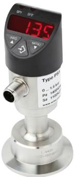
Grâce au raccord sanitaire directement associé au corps de l'instrument qui ne génère donc aucune face d'étanchéité supplémentaire en contact avec le process, le transmetteur de pression SA-11 est bien plus « propre » qu'un appareil à membraneaffleurant associé à un raccord adaptateur. Et par rapport à un transmetteur standard monté sur séparateur, il garantit un bien meilleur niveau de performance car dérivant bien moins en précision en cas de variations de la température du fluide process.
