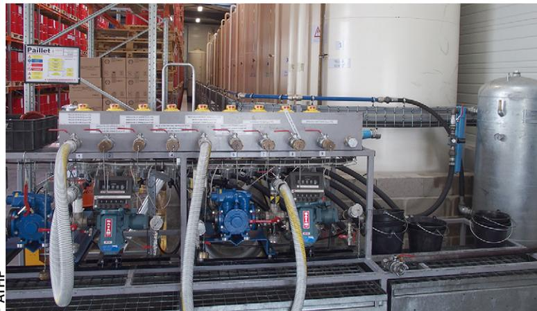
Automatisation d'une chaîne de distribution de fluides avec interface IHM.
