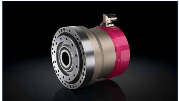
Les servomoteurs Harmonic Drive diffèrent des moteurs classiques brushless car ils intègrent un réducteur mécanique sans jeu elliptique avec un haut rapport de réduction (entre 50 et 160). © Harmonic Drive
