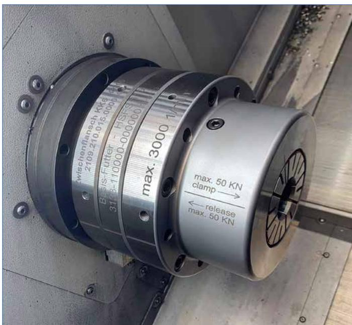
La gamme de serrage de précision de Ringspann est entièrement mécanique, ce qui lui confère une grande fiabilité et peu d'entretien. © Ringspann
