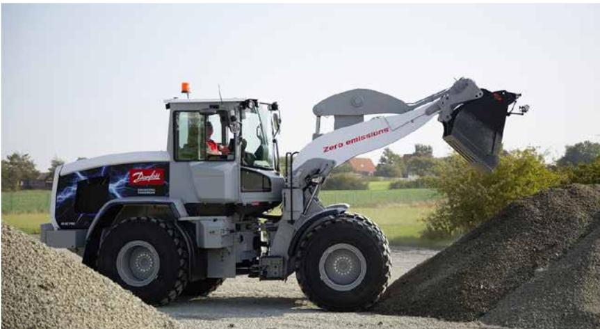
Pelleteuse électrique développée par le groupe danois. © Danfoss Power Solution
