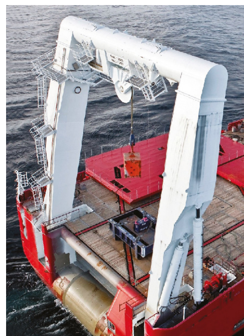
Vérin de diamètre 550 monté sur châssis en A.
