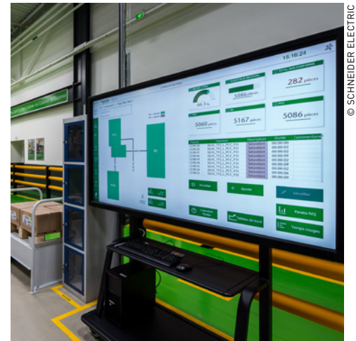
Le management de la performance a été grandement amélioré sur le site du Vaudreuil avec la mise en œuvre d'outils digitaux permettant de visualiser en temps réel les différentes données de production.
