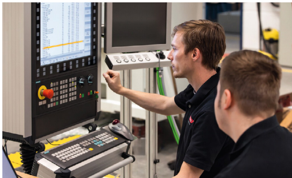
Depuis le poste de commande, l'opérateur peut accéder à chaque capteur individuellement.
