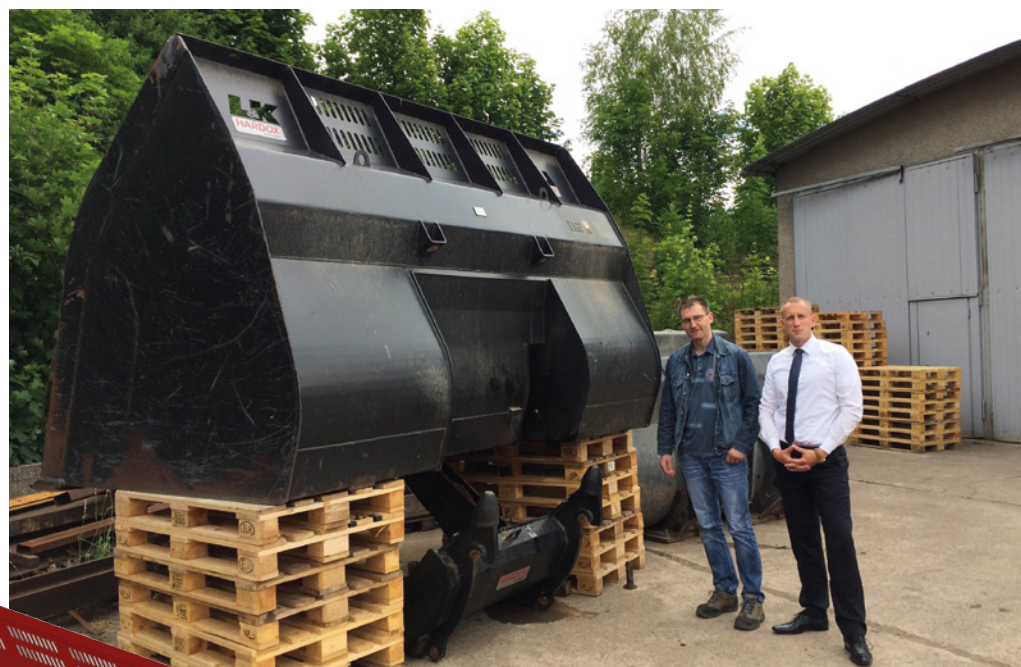
Godet à haut déversement de 8,5 m 3 équipé de paliers lisses iglidur
