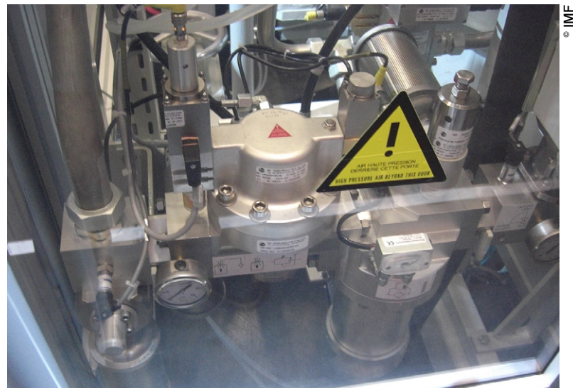
Ligne de détente IMF sur machine de soufflage du P.E.T.
