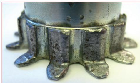
Figure 14 : Stade ultime d'usure par abrasion d'une roue dentée.
