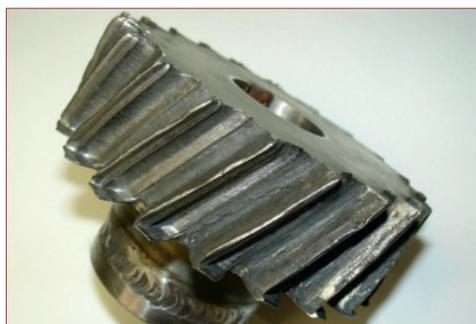
Figure 15 : Usure par abrasion diminuant la largeur de la dent.
