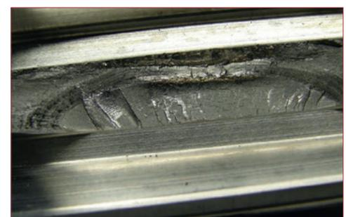
Figure 11 : Rupture par fatigue causée par une sollicitation en flexion alternée en pied de dent. Présence de lignes d'arrêts marquant le caractère progressif de la rupture.
