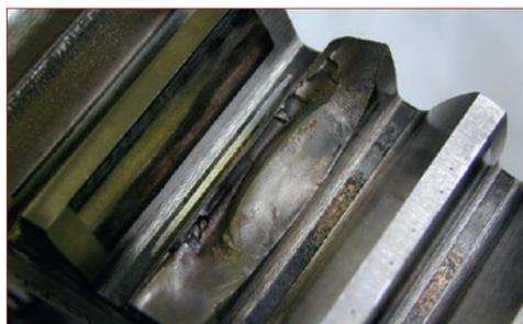
Figure 12 : Dent rompue par fatigue par flexion alternée en pied de dent. La partie lisse est la zone de propagation de la fissure avant la rupture complète de la dent.
