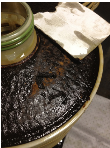
2. Varnish sur l'élément filtrant
