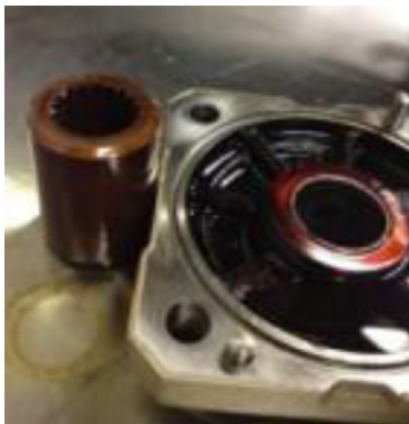
1. Varnish sur le couvercle de la pompe hydraulique
