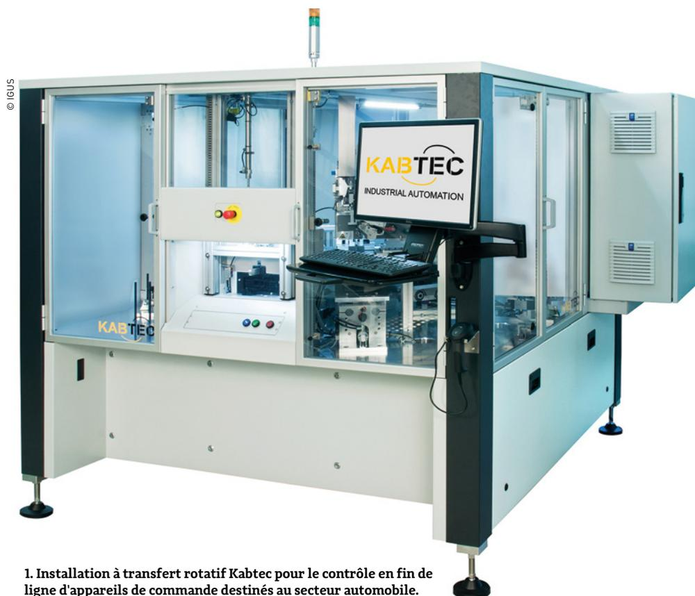
1. Installation à transfert rotatif Kabtec pour le contrôle en fin de ligne d'appareils de commande destinés au secteur automobile.
