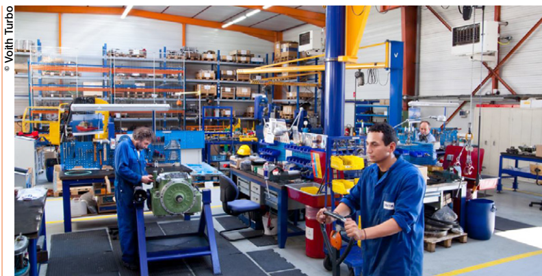
Le banc d'essais de pompes hydrauliques de l'atelier de Noisy-le-Grand a bénéficié d'un retrofit complet lui permettant de fonctionner jusqu'à des pressions de 400 bar et des cylindrées de 250 cm³.
