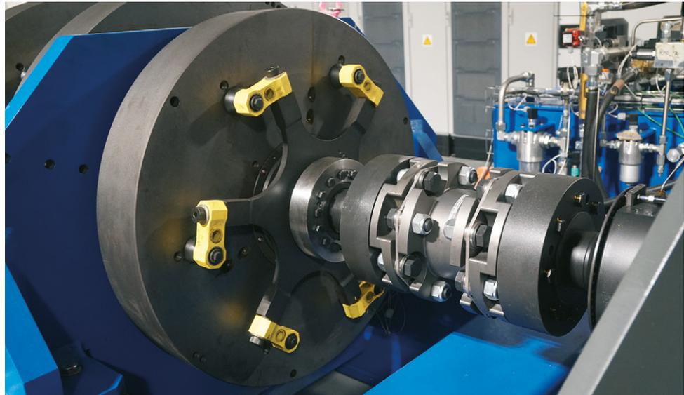
Test d'endurance des éléments de transmission.
