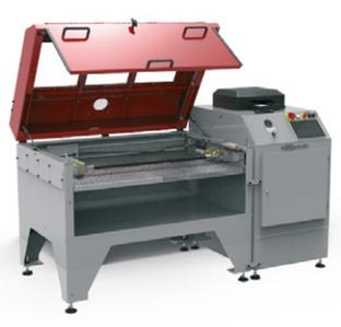
La gamme de bancs de test Techmaflex est conçue pour les applications hydrauliques, automobiles et industrielles. Sa plage de test est comprise entre 45 à 2500 bars, ajustable afin de répondre aux besoins. Différentes versions sont disponibles, de la simple configuration avec manomètre 0-2500 bars jusqu'à la version production, équipée d'un écran tactile 10" avec affichage numérique des mesures et impression des rapports de test.
