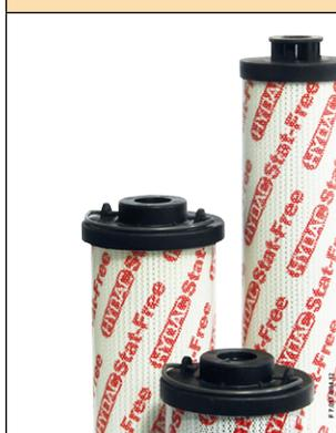
Stat-Free® est une toute nouvelle technologie d'élément filtrant protégeant de manière certaine les systèmes hydrauliques et de lubrification contre les phénomènes de charges et de décharges électrostatiques : pas de différence de potentiel générée par l'élément filtrant, charge électrostatique du fluide d'un niveau négligeable, sécurité de fonctionnement élevée, augmentation des intervalles de changement d'huile.
