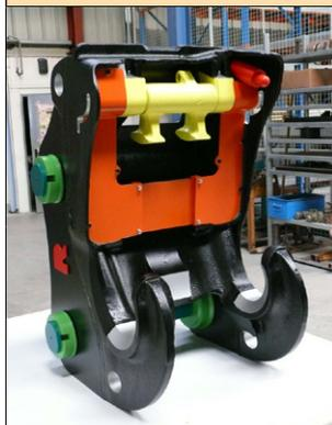
Hydraumatec en partenariat avec IFM répond au besoin de Morin pour leur nouvelle attache hydraulique qui permet d'accrocher et de décrocher des godets automatiques. La nouveauté est visible par la sécurité active automatique : gestion permanente et automatique de la sécurité excluant tout déverrouillage accidentel., affichage en cabine d'infos sur l'état du coupleur et sur le contrôle permanent de la sécurité.
