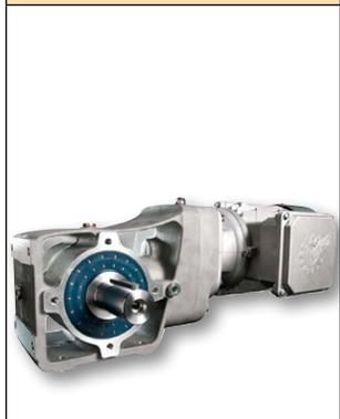
Ces réducteurs à couple conique à deux trains sont conçus pour pouvoir subir un lavage fréquent car dépourvus d'espaces morts où pourraient s'accumuler saletés et liquides. Ils supportent les lavages fréquents, intenses et agressifs à base de solutions acides et alcalines. Fabriqués en aluminium coulé, ils offrent une bien meilleure résistance à la corrosion que les modèles en acier.
