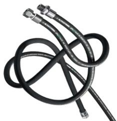
Les tuyaux alfabiotech (ISO 18752) sont conçus pour résister aux huiles bio. La gamme est composée de tuyaux haute pression, en caoutchouc synthétique avec armature nappée (4). Extra flexible, leur rayon de courbure est réduit de 50% comparé au SAE 100R. Avec une forte résistance aux conditions difficiles, ils s'utilisent sous très haute pression et à des températures allant de -40°C à 121°C. Revêtement Minetuff pour une grande résistance à l'abrasion, à l'ozone et aux hydrocarbures.
