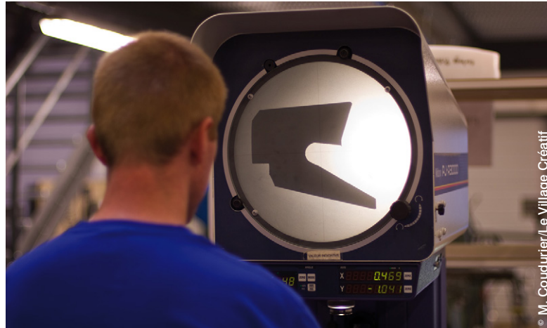
Projecteur de profils CNC permettant un contrôle régulier de la qualité d'usinage et du respect des tolérances des pièces produites.
