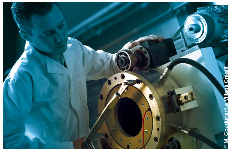
Matériel R&D - Banc rotatif à forte excentration pour joints à lèvres (200 bar maxi)
