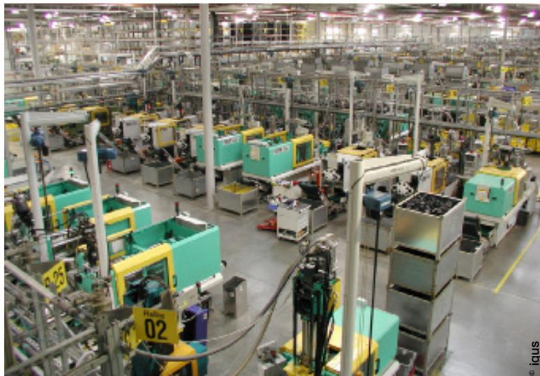
Les 320 presses d'injection de son usine de Cologne font d'igus « le plus important utilisateur de matières plastiques en Allemagne ».
