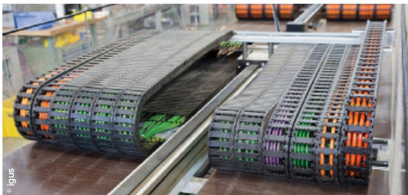
La société igus peut accorder une garantie sur sa gamme chainflex M parce qu'elle soumet en permanence ses câbles et systèmes à des tests en conditions réelles. Deux milliards de cycles de tests sont effectués tous les ans sur les 180 bancs d'essais que comptent les 1.750 m<sup>2</sup> de son propre laboratoire de test.
