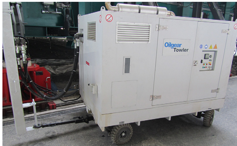
Deux centrales hydrauliques mobiles dotées chacune d'un réservoir de 1.000 litres et d'une pompe à cylindrée variable, type PVV entraînée par moteur thermique, suivent le plateau sur chacun de ses côtés.
