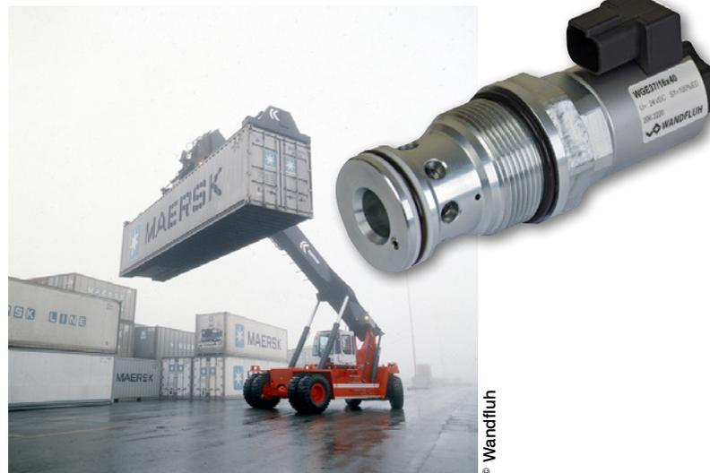
Les valves à clapet en cartouche de Wandfluh M42x2 peuvent passer un débit de 300 l/mn sous 350 bar. Elles sont utilisées partout où des fonctions de fermeture étanches telles que maintien sans fuites de charges, de serrages ou de pinçages sont d'importance capitale. La valve à clapet en cartouche est principalement destinée à la construction des blocs forés pour usage mobile.
