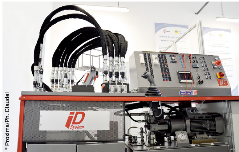
Banc "Pédagogie par la pratique" reprenant le principe d'un système réel (nacelle élévatrice).
