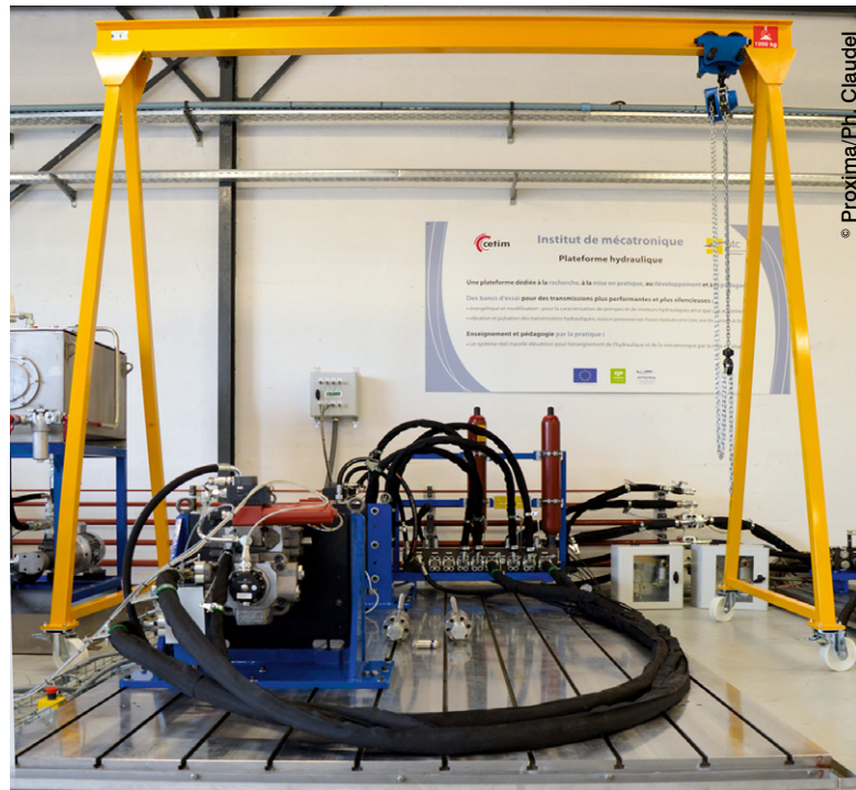
Banc énergétique et modélisation, capacité nominale 75 kW, 500 N.m, 3400 tr/min.
