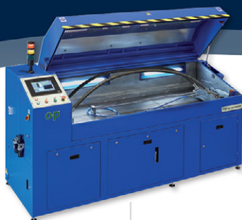
Banc à eau ou huile jusqu'à 2000 bar , avec multiplicateur hydro-pneumatique
