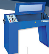
Banc d'essai jusqu'à 1200 bar , avec multiplicateur hydro-pneumatique, série ECO , très facile à utiliser. Contrôle et relâchement de la pression, test et remplissage du liquide effectués manuellement
