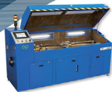
Banc pour tests d'éclatement jusqu'à 4500 bar , avec multiplicateur hydro-pneumatique
