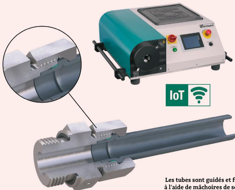
Les tubes sont guidés et formés à l'aide de mâchoires de serrage et de façonneurs de tubes.
