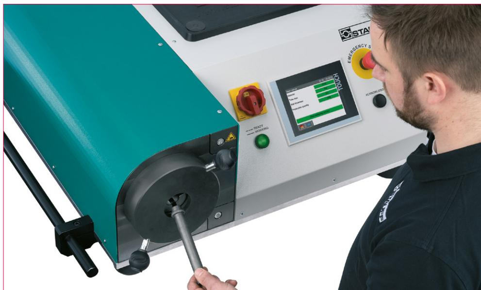
La machine de table robuste, conçue pour une utilisation permanente dans les ateliers, exécute le processus de formage après un démarrage manuel.
