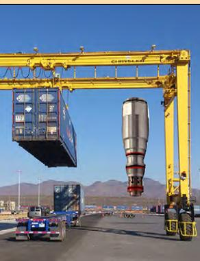
Les valves LoadMatchTM en autocontrôlant automatiquement leur tarage lorsque les charges sont moindres, permettent de minimiser le gaspillage d'énergie durant les cycles où la charge est inférieure au maximum. Un test réalisé avec des valves LoadMatchTM sur un porte conteneur automoteur de 260 CV qui charge et décharge des trains et des camions, a mis en évidence une diminution de sa consommation de carburant de 3,8 l/h, permettant un ROI en quelques jours.
