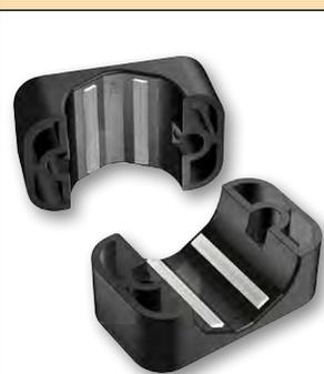
Les colliers Stauff ACT sont conçus pour l'installation de tuyauteries d'instrumentation où les propriétés d'anti-corrosion sont d'une importance capitale. Ils garantissent une prévention efficace de la corrosion caverneuse sous les colliers de fixation des tuyauteries en acier inoxydable. Ils permettent de réaliser des économies à moyen et long terme grâce aux intervalles de maintenance prolongés.
