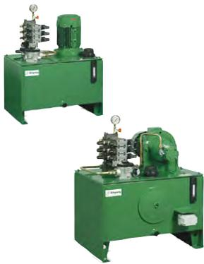
Ethywag propose une gamme complète de centrales hydrauliques : réservoirs de 6 à 2.000 litres, débits de 1,5 à 200 l/mn, moyenne ou haute pression (200 bar, 350 bar, 700 bar), puissance 0,25 à 75 kW. Fabrications selon schémas existants ou étudiés par son bureau d'études. Equipements complets avec vérins et moteurs hydrauliques.
