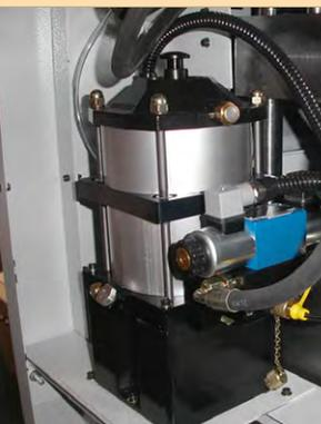
Les pompes pneumo-hydraulique PMPO d'Enerfluid permettent de commander des vérins simples ou doubles effets hydraulique ou de petits outillages fonctionnant sur une pression de 3 à 8 bars. Elles peuvent être équipées d'un bloc de décharge ou d'un bloc embase pour distributeur hydraulique et d'un réservoir de 6 litres. Pression hydraulique jusqu'à 320 bars. Ces pompes sont utilisées pour des opérations de pliage, marquage, découpage et poinçonnage.
