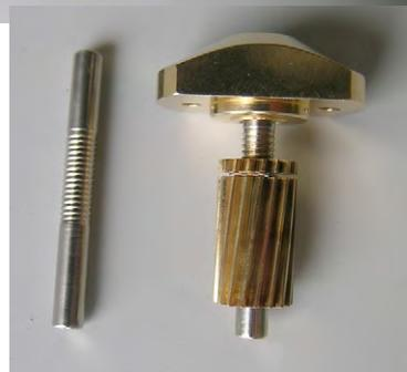
Pour équilibrer l'instrument, un écrou en laiton se déplace sur une vis filetée roulée fournie par Eichenberger et déplace un petit contrepois (à gauche).
