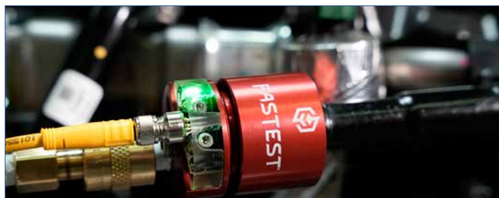
La technologie FasTest permet d'effectuer en toute sécurité les connexions nécessaires pour exécuter un test de fuite. © OI Technologies
