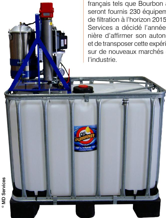
Cette centrale de dépollution montée sur un réservoir de 600 litres est équipée d'un réchauffeur, d'un pré-filtre et d'un tableau de commandes.
