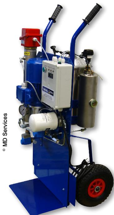
Il est possible de transporter l'équipement sur les chantiers et de traiter l'huile en quelques heures sans arrêter la production.
