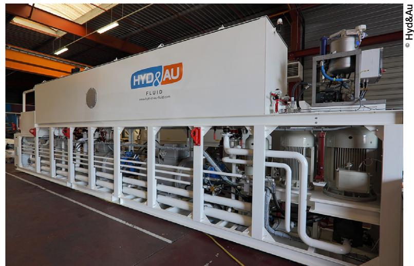
Centrale hydraulique destinée à un tunnelier NFM : 11 mètres de longueur / réservoir de 10 000 litres.
