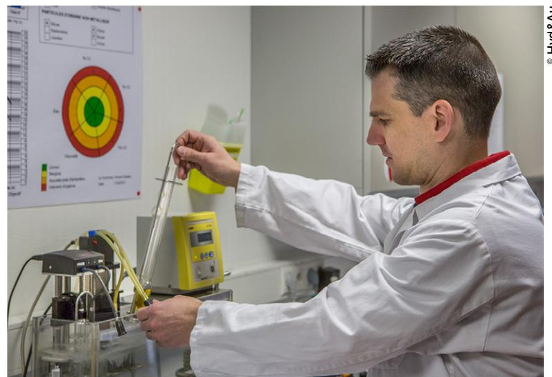
Plusieurs milliers d'analyses de fluides sont réalisées chaque année au sein du laboratoire de Saint-Ouen-l'Aumône qui a été doté de nouveaux outils permettant de contrôler le vieillissement physico-chimique de l'huile dans une optique de maintenance proactive des équipements.
