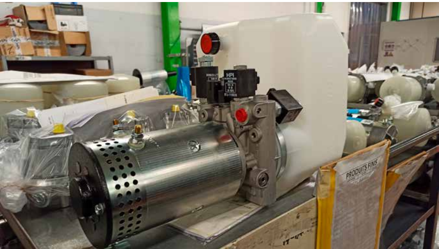
Pompe hydraulique Pompe hydraulique assemblée sur le site HPI de Chennevières sur Marne. © Karim Boudehane
