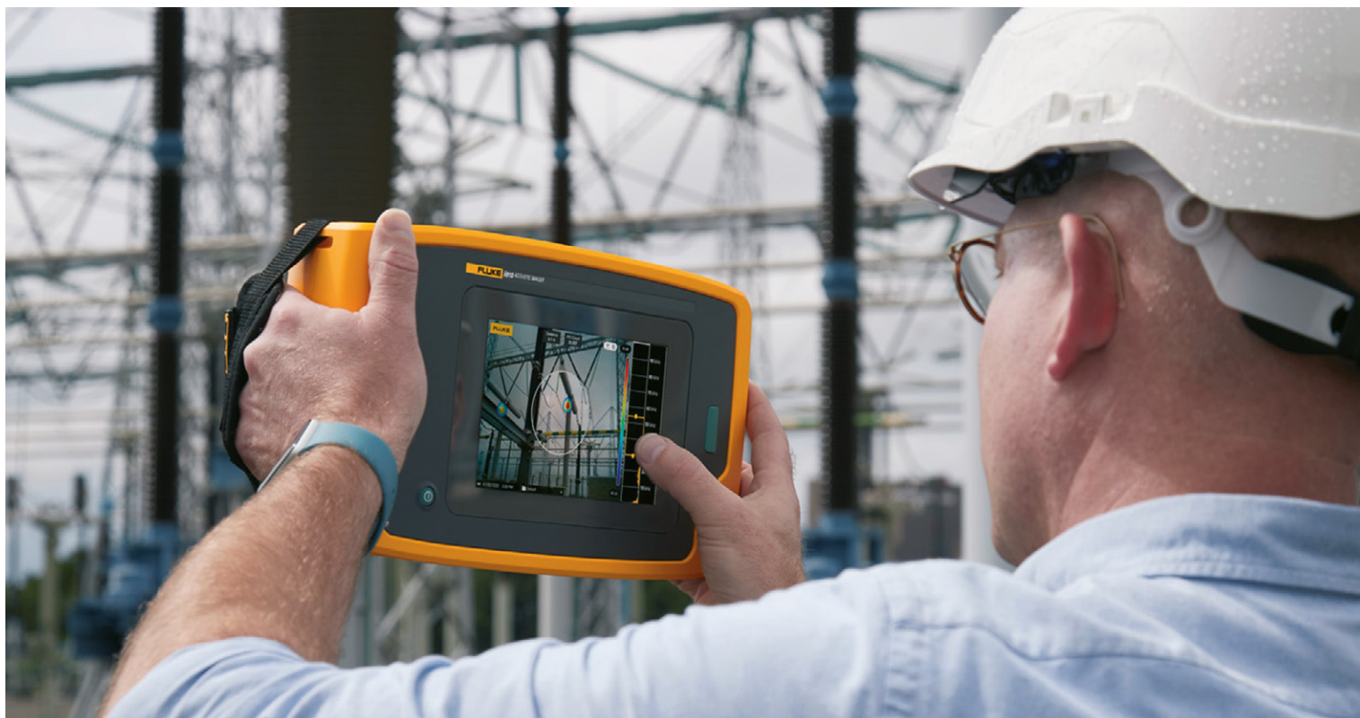
L'imageur acoustique de précision ii910 de Fluke a un double usage pour la détection des fuites d'air comprimé et des rejets de particules.
