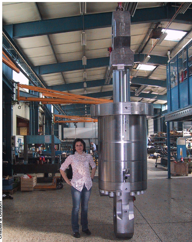
Vérin de tensionneur pour pose de pipe.
