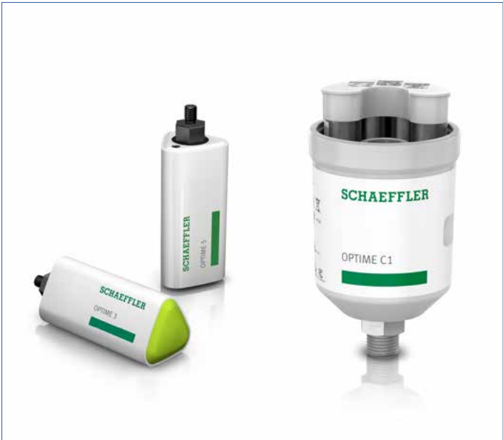
L'Optime C1 de Schaeffler délivre la graisse nécessaire (cartouches de 125 cm 3 ) à partir des informations de l'Optime, qui fait de l'analyse vibratoire et peut détecter les problèmes de lubrification. © Schaeffler
