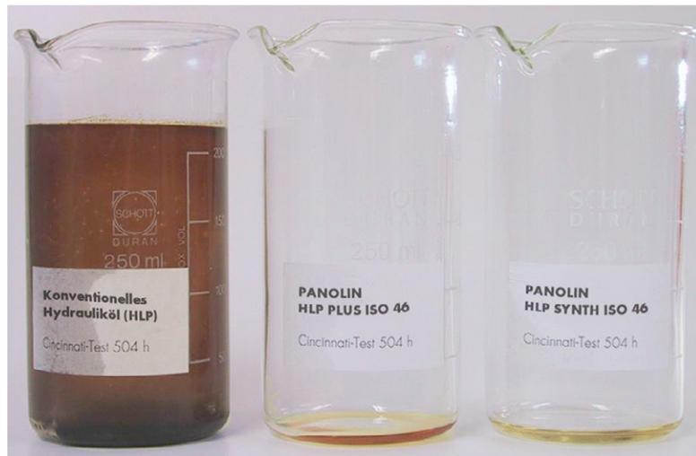
Test d'oxydation Cincinnati.
