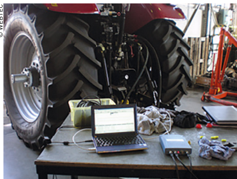
La solution élaborée par Webtec prévoit une interface avec les ordinateurs portables déjà en usage et contenant les manuels techniques de tous les équipements.
