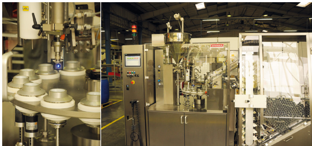
La machine de remplissage de tubes Citus Kalix KX1103, actuellement équipée de trois servovariateurs MCS Lenze 9300, fonctionnera bientôt avec la solution d'automatisation i700 de Lenze.
