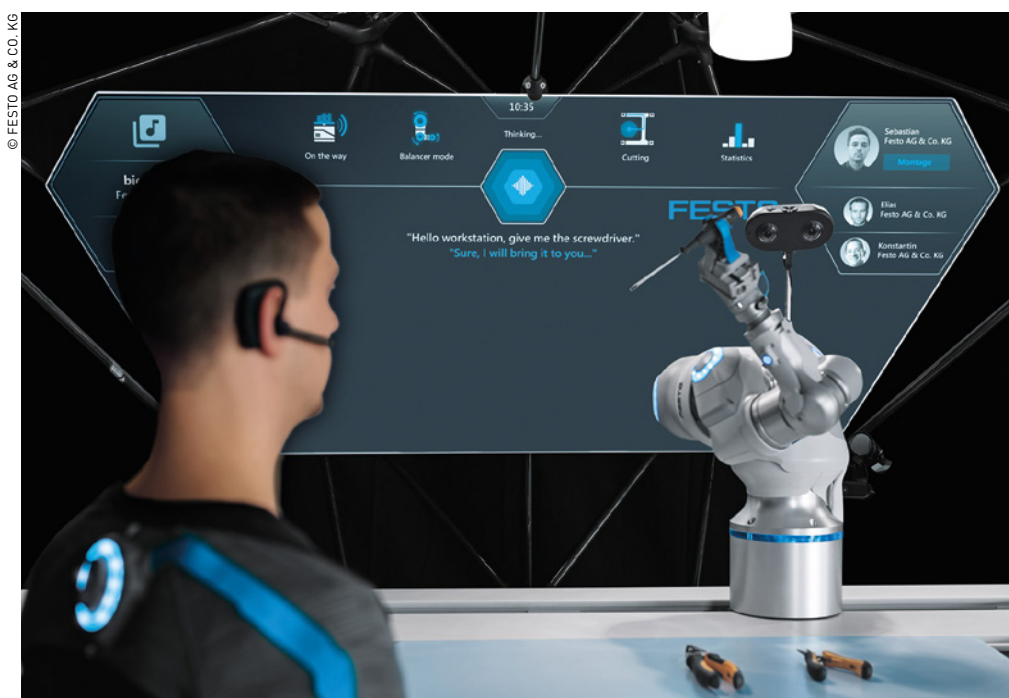
L'humain peut commander le BionicCobot par le mouvement, le contact ou la voix de manière intuitive.
