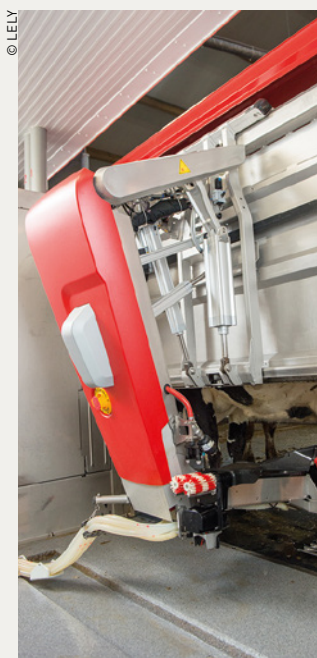
Bras robotisé du robot de traite Lely Astronaut A5, équipé d'actionneurs électriques Festo et des logiciels correspondants.
