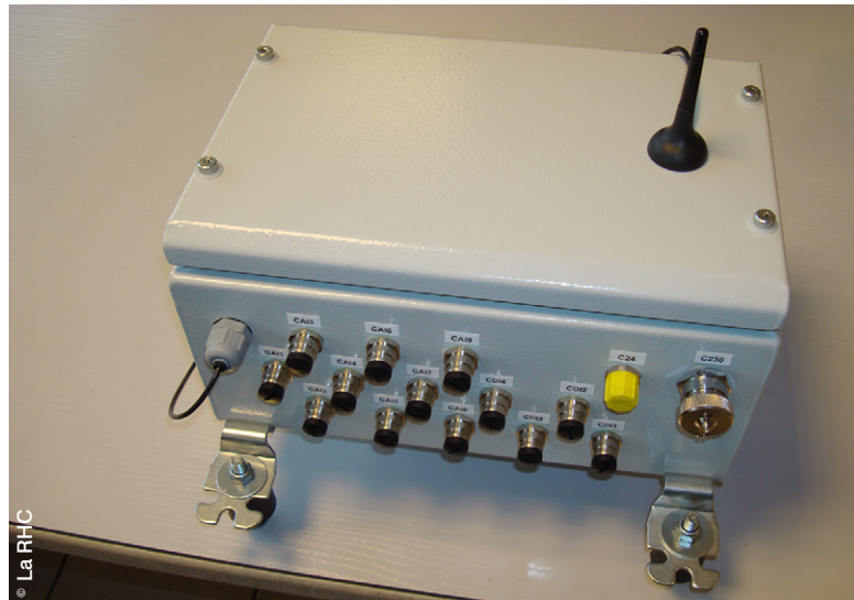
Les nouvelles technologies permettent d'instrumenter les installations sensibles telle que la Surbox du réseau d'hydrauliciens de La RHC, qui permet aussi d'équiper des machines existantes.
