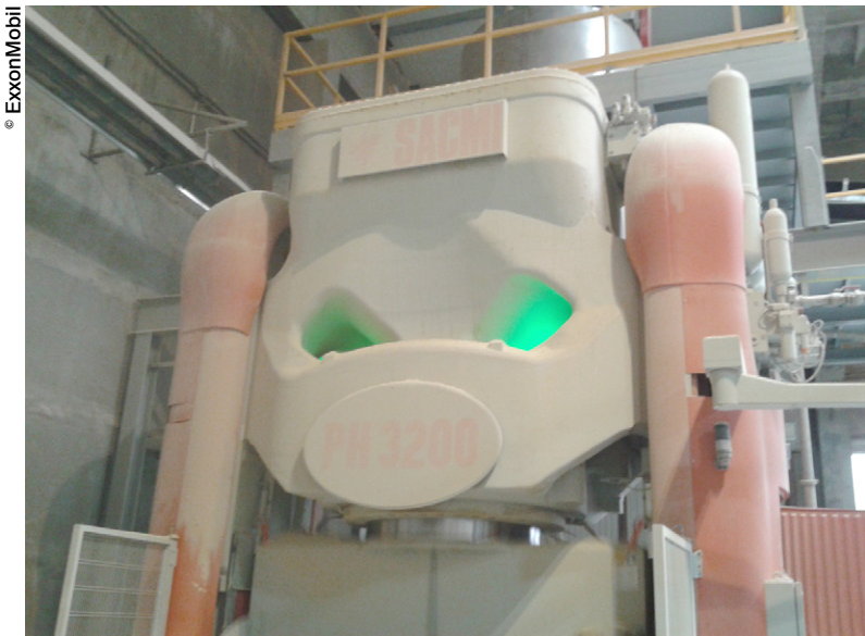
La presse Sacmi Imola PH-3200 Android d'une puissance de 3.200 kW fonctionne à des pressions élevées, de 370 à 400 bar. Le tout à des températures de service dépassant les 100°C.
