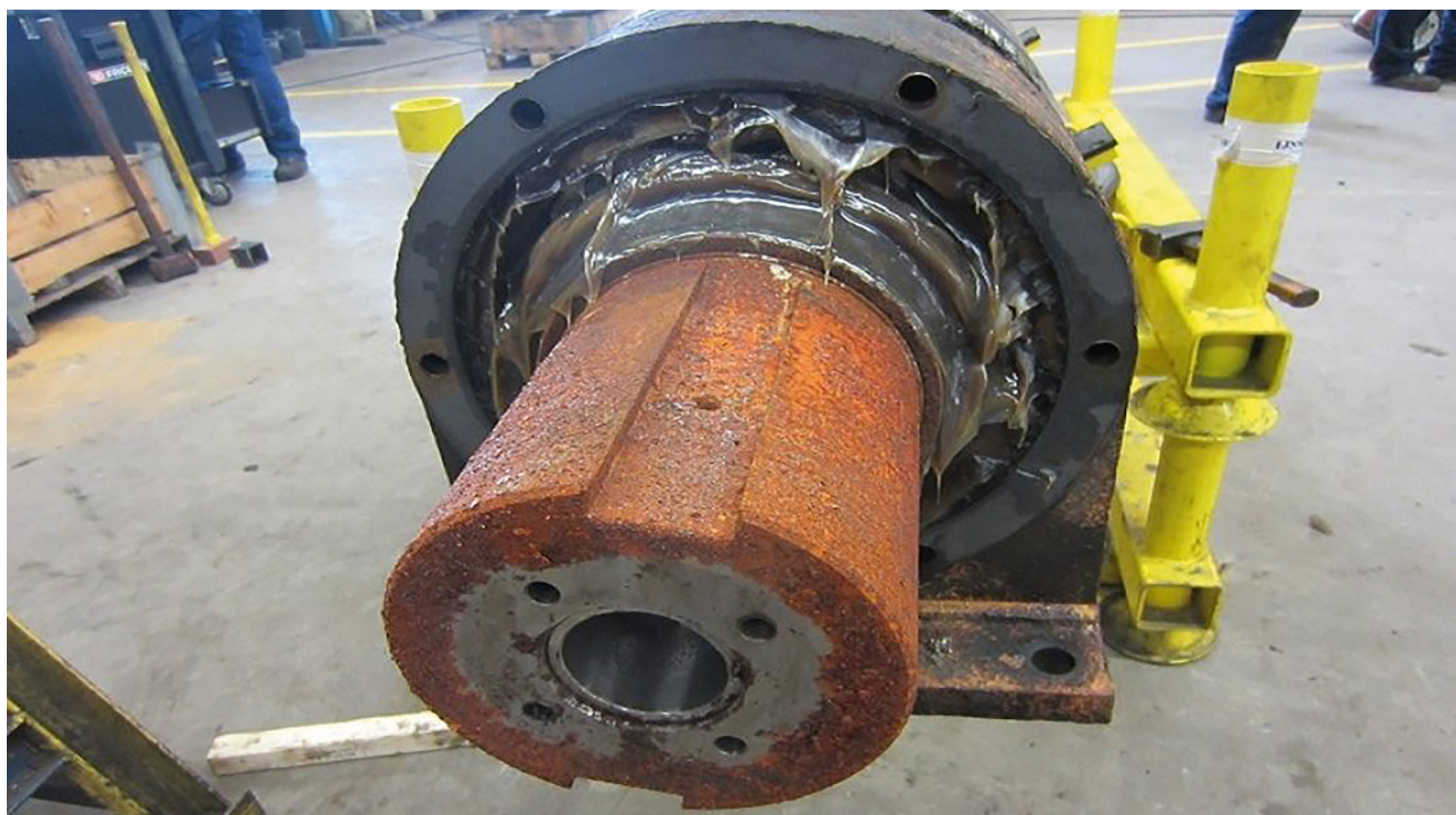
Roulements et paliers à rouleaux NSK SWR sur un axe d'une machine de coulée continue.
